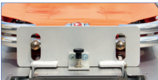
Trage 12-2 mit der Befestigungsplatte gesichert
