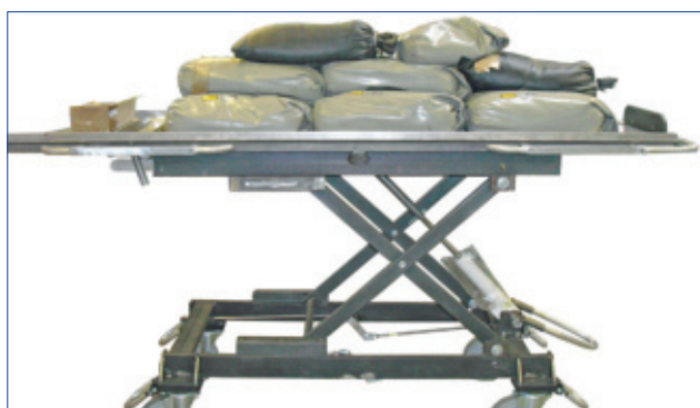
Statischer Belastungstest am Prototypen
