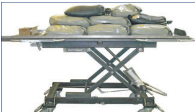
Statischer Belastungstest am Prototypen
