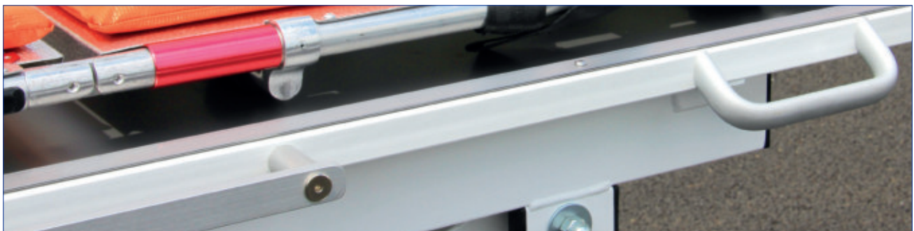
Rundum angebrachte Führunggriffe aus eloxiertem Aluminium und Normschienen zur Anbringung von Geräten gehören zur Grundausstattung.
