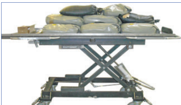
Statischer Belastungstest am Prototypen
