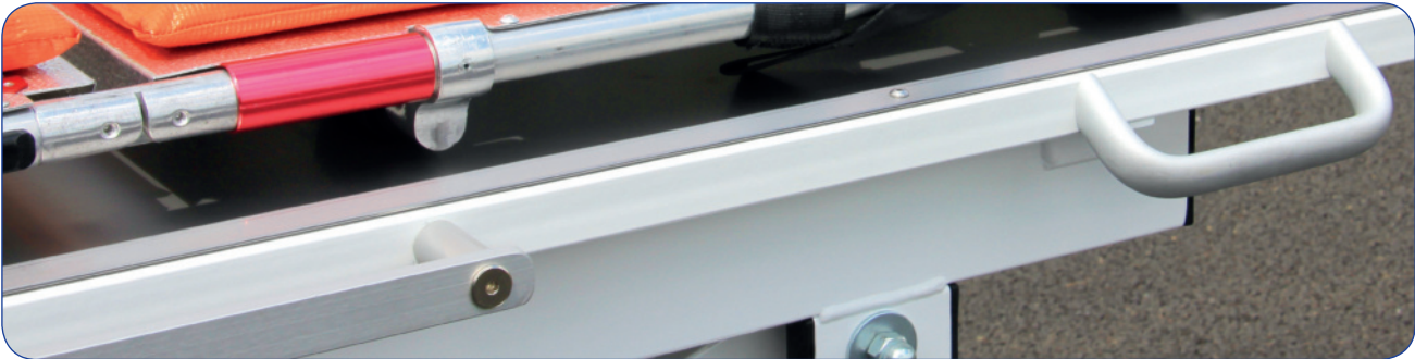
Rundum angebrachte Führungsriffe aus eloxiertem Aluminium und Normschienen zur Anbringung von Geräten gehören zur Grundausstattung.
