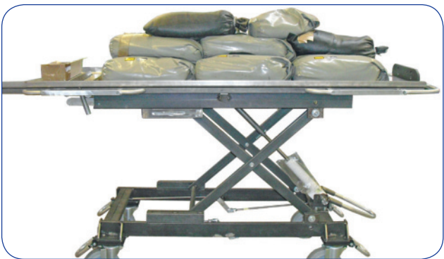
Statischer Belastungstest am Prototypen
