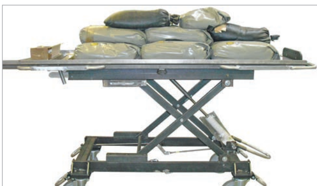
Statischer Belastungstest am Prototypen
