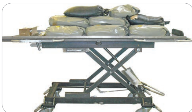
Statischer Belastungstest am Prototypen
